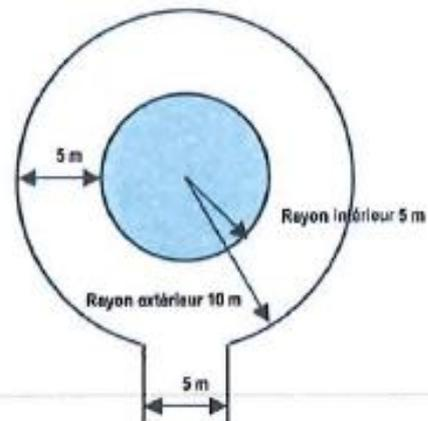
Nota : les rayons de braquage de 5 m en intérieur et 10 m en extérieur sont donnés pour les bennes de collecte en porte-à-porte 26 T. Ces rayons de braquage doivent être portés à 7 m en intérieur et de 12 m en extérieur pour les manœuvres réalisées par les bennes de collecte en apport volontaire 32 T.
